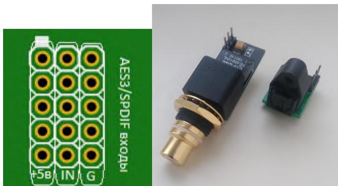
Оптический вход TOSLINK выполнен на основе приёмника PLR135/T9 от Everlight. Поддерживает частоту цифрового потока до 16Mb/s (частоты дискретизации звуковых данных 44,1-192,0кГц).
